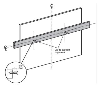
Ajuster la profondeur des vis de montage originales dans le support en bois jusqu'à ce qu'elles ressortent de 1/4". Ce dépassement de 1/4" va permettre d'accrocher la hotte.
