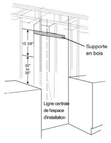
Sécuriser le support en bois avec 2 ou plus attaches verticales en utilisant au moins 2 des 4 longues vis fournies.
