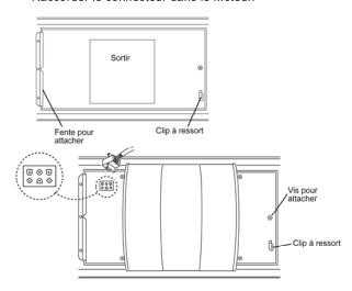
Installer le filtre anti-graisse et remettre le courant à la boîte à fusible. Vérifier le fonctionnement de la hotte.
